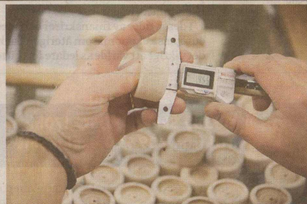
Översidan på trähatten, den blivande korken, har frästs ut. Nils Helmuth mäter så att djupet är det rätta.
